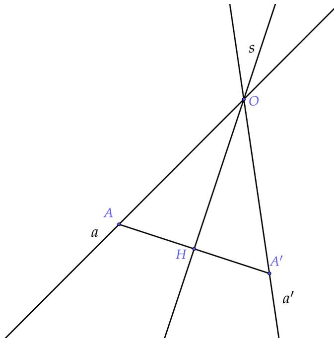
Figura 5.3. Eje de simetría y bisectriz de un ángulo.
