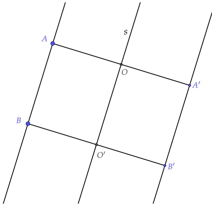
Figura 5.5. Simétrico de un segmento paralelo al eje de simetría.
