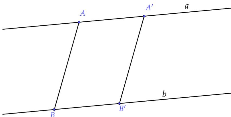
Figura 5.16. Segmentos paralelos comprendidos entre rectas paralelas.
