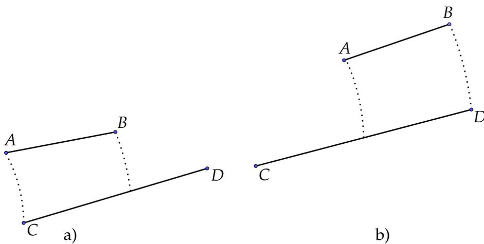
Figura 2.5. Transporte de un segmento sobre otro con un extremo coincidente.
