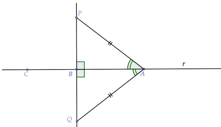
Figura 2.27. Construcción de una perpendicular por un punto interno de una recta.
