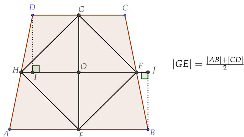
Figura 5.23. Cuadrado formado por los puntos medios de un trapecio isósceles.
