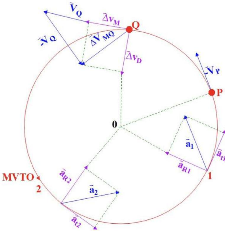
Figura 1.23. movimiento circular uniformemente variado.
