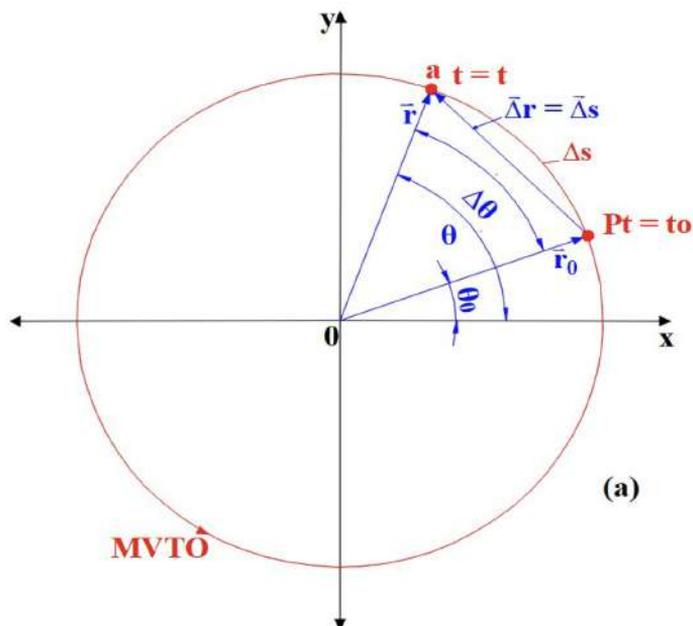
Figura 1.20. Relación entre el desplazamiento lineal ( $\Delta S$ ) y el desplazamiento ( $\Delta\theta$ ).
