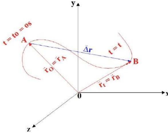
Figura 1.1. Vector posición-desplazamiento.
