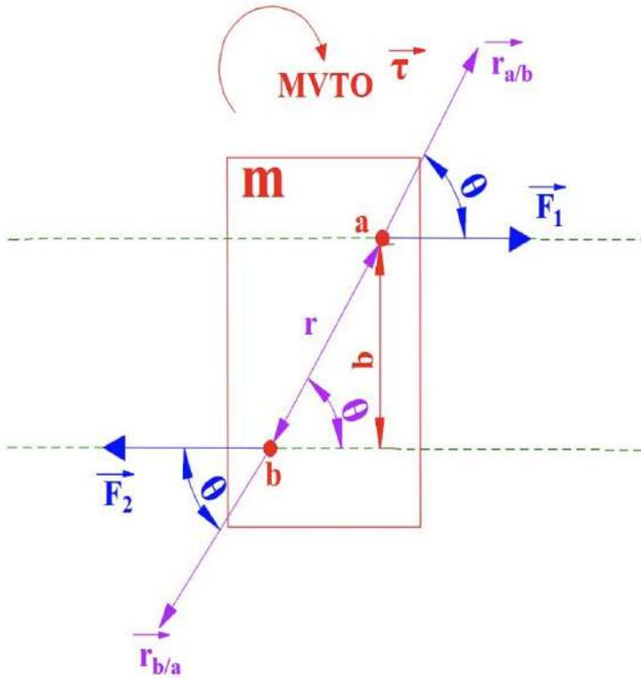
Figura 4.2. Definición del torque.
