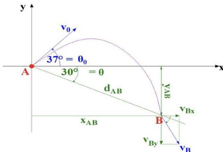
Figura 2.23. Ejercicio de movimiento parabólico.
