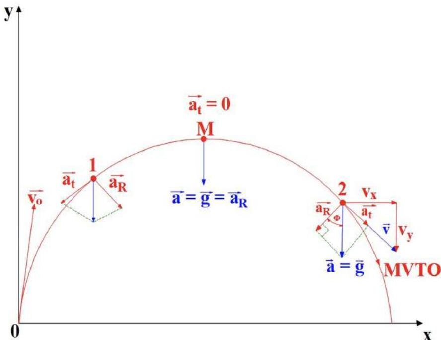
Figura 1.18. Componentes de la aceleración:  $\vec{a}_t$  y  $\vec{a}_R$ .
