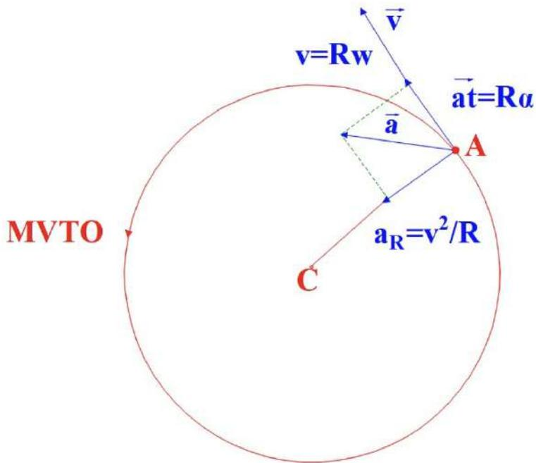
Figura 1.26. Componentes tangencial y radial de la aceleración.
