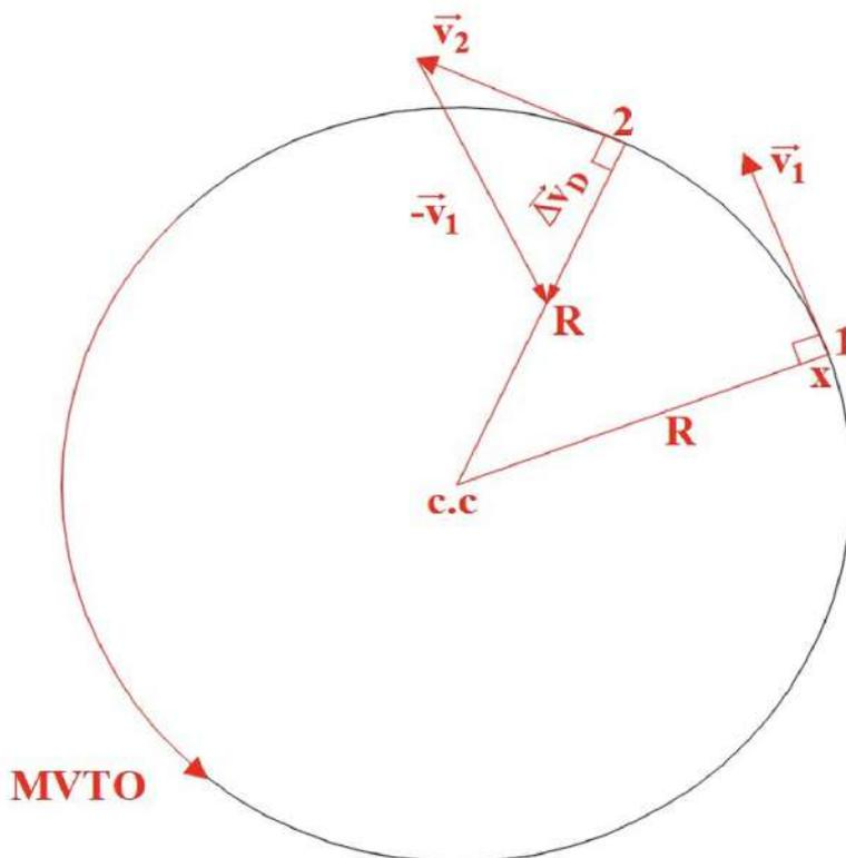
Figura 1.5. Determinación gráfica del vector variación de velocidad en dirección y sentido.
