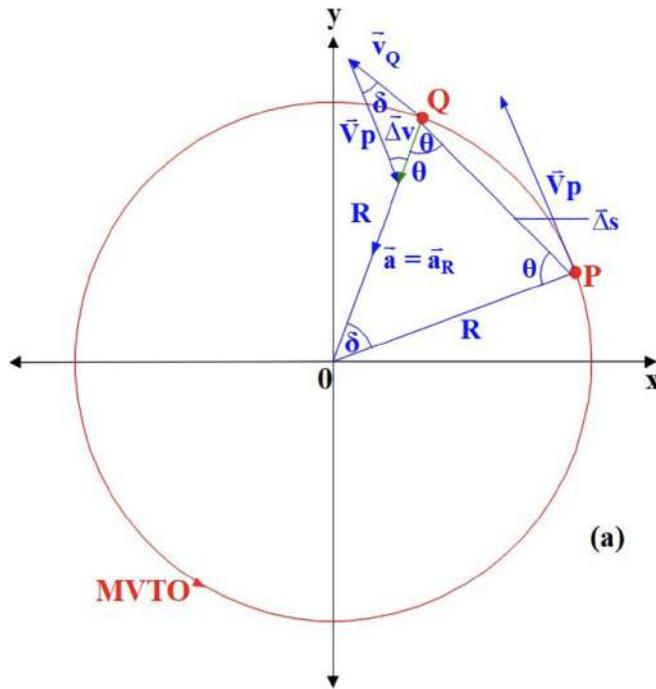
Figura 1.21. Aceleración en el movimiento circular uniforme.
