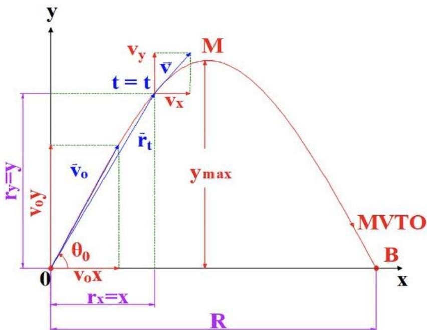
Figura 1.17. Trayectoria movimiento. parabólico y sus variables.
