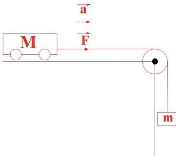
Figura 3.3. Segunda ley de Newton (en la traslación).
