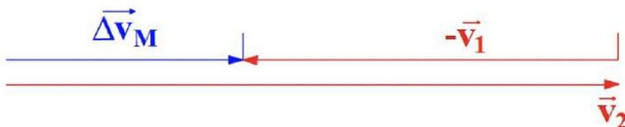
Figura 1.4. Determinación gráfica del vector  $\vec{\Delta v}_M$ .
