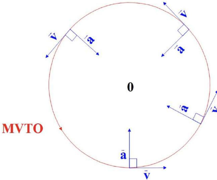
Figura 1.22. Movimiento circular uniforme.
