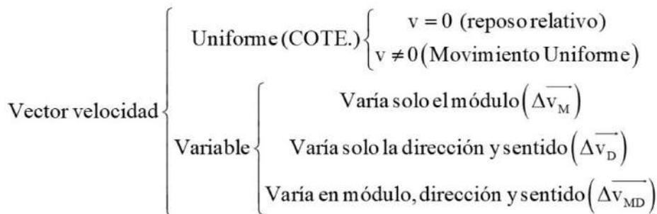
Figura 1.9. Clasificación del movimiento según el comportamiento del vector velocidad.
