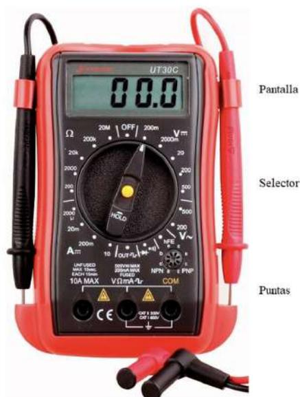
Figura 2.66. Partes del voltímetro
