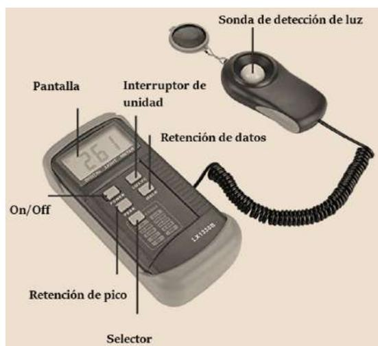
Figura 2.30. Partes del luxómetro digital
