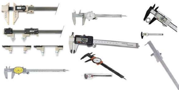
Figura 2.94. Tipos de calibrador
