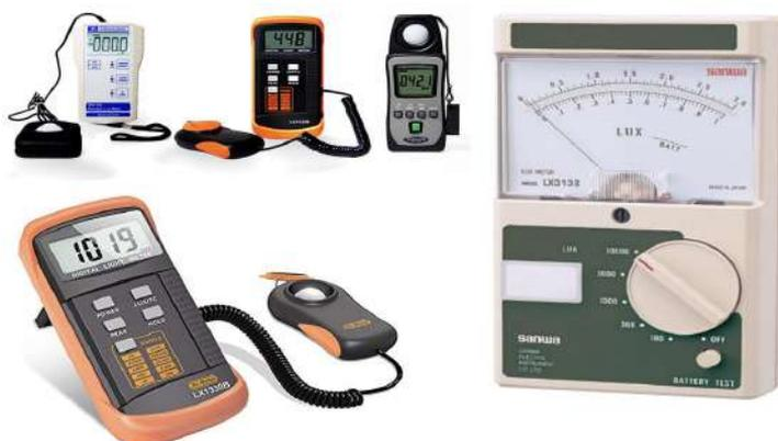
Figura 2.29. Tipos de luxómetros
