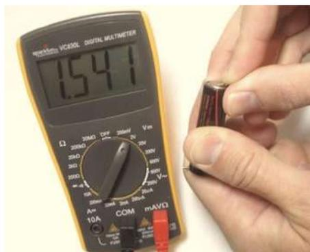
Figura 2.72. Medición con multímetro digital
