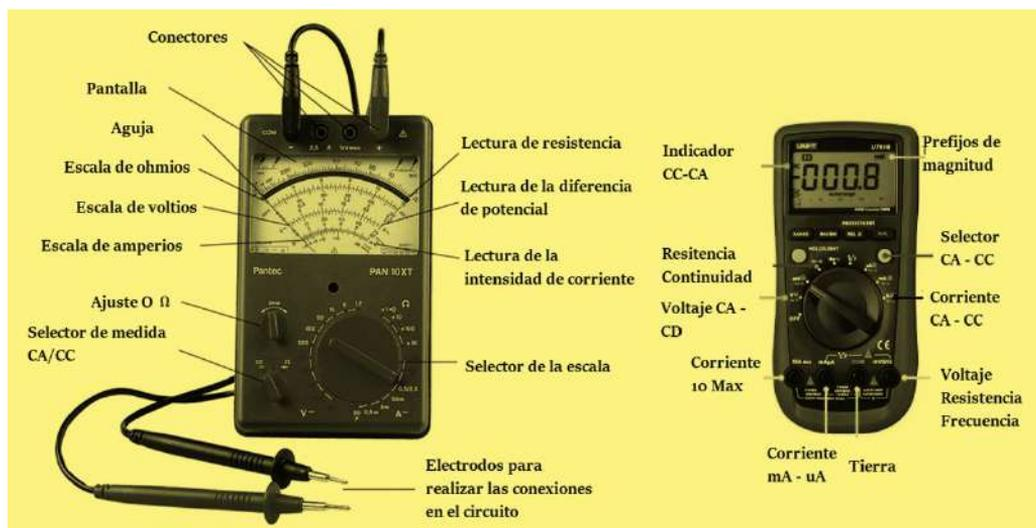
Figura 2. 74. Partes del multímetro
