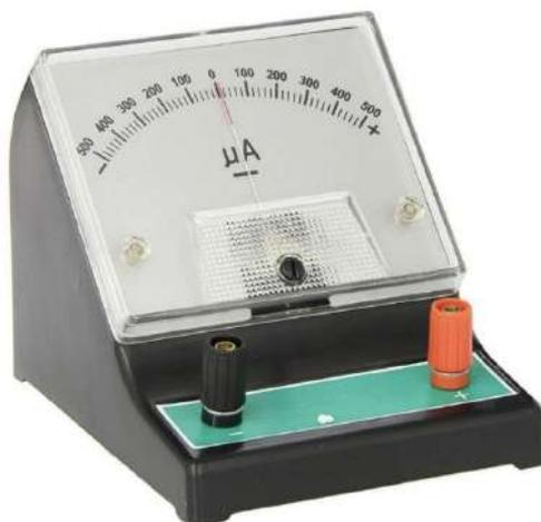
Figura 2.52. Galvanómetro analógico
