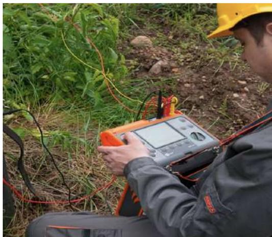
Figura 2.81. Aplicación del telurómetro.
