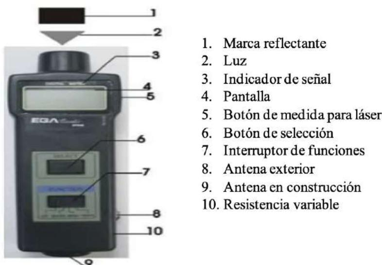
Figura 2.20. Partes del tacómetro digital
