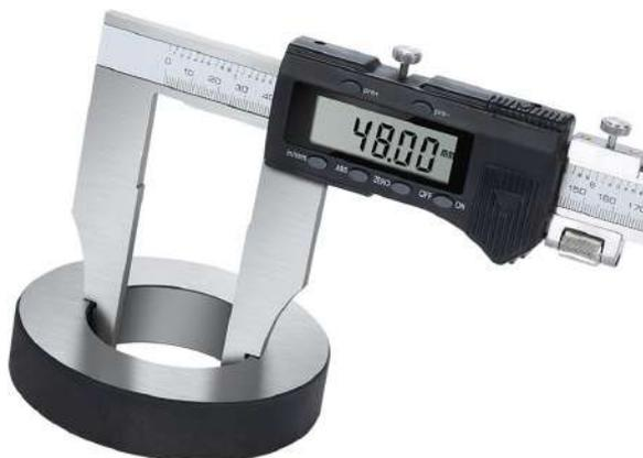
Figura 2.96. Calibrador digital
