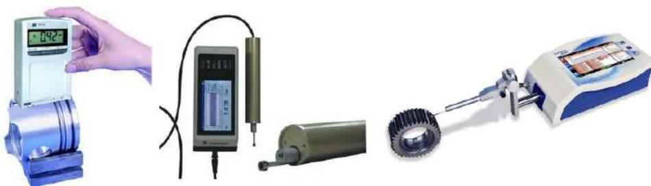
Figura 2.8. Tipos de rugosímetros
