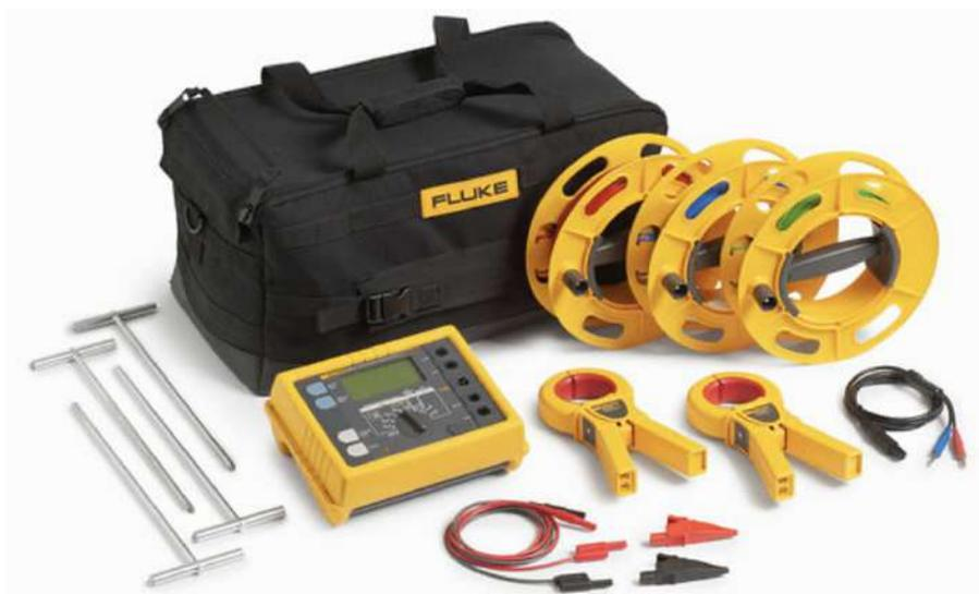
Figura 2.76. Telurómetro
