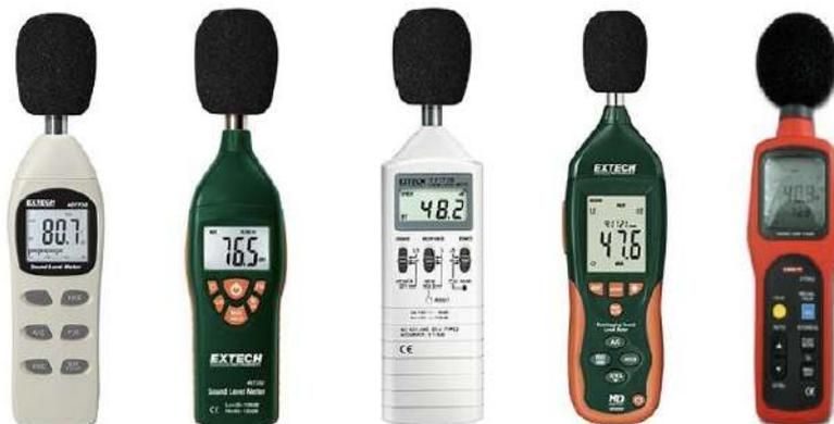
Figura 2.2. Tipos de sonómetros digitales
