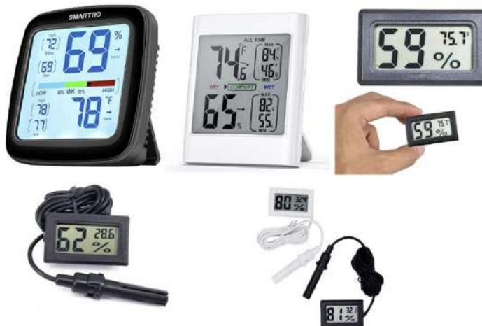
Figura 2.39. Tipos de higrómetros
