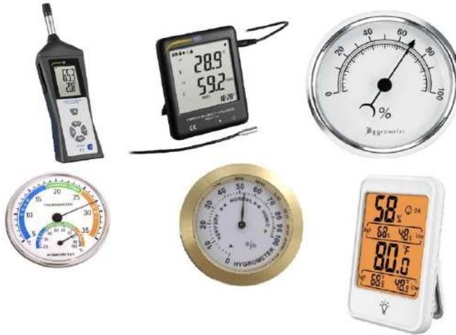
Figura 2.38. Higrómetro digital y analógico
