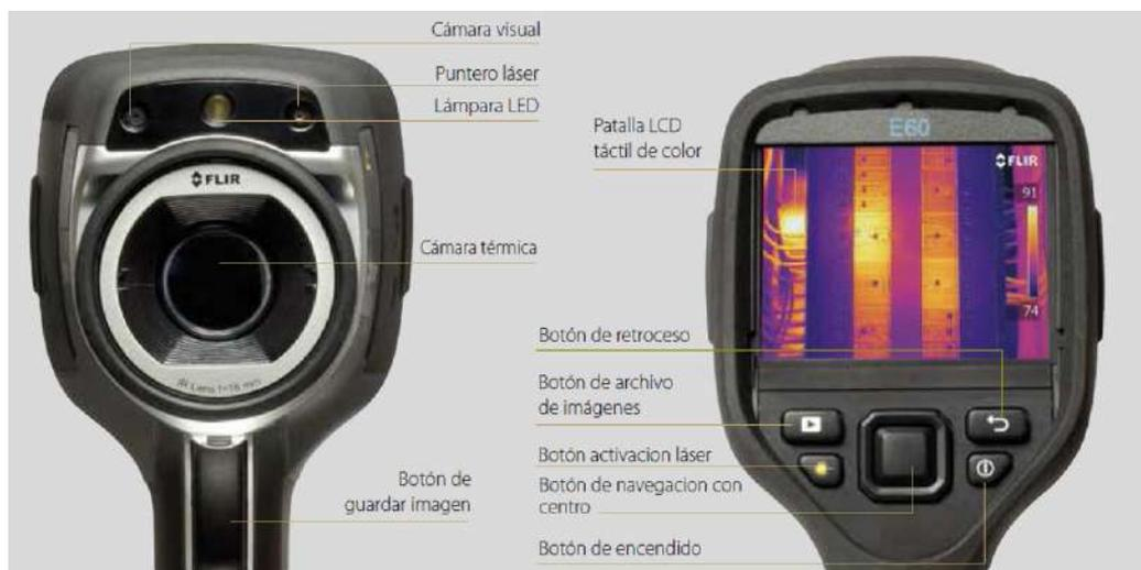
Figura 2.85. Partes de la cámara termográfica
