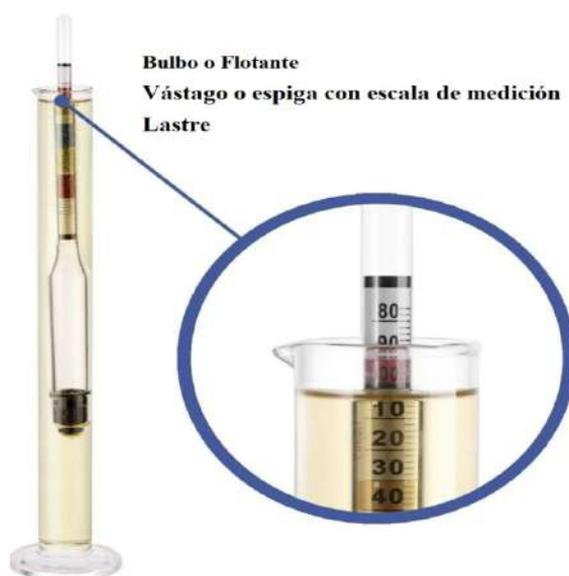
Figura 2.35. Partes del densímetro
