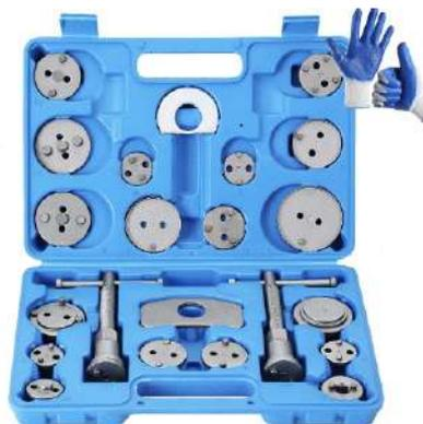
Figura 3.13. Reposicionador de pistones de freno
