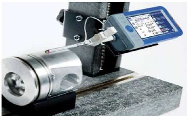
Figura 2.11. Aplicación del rugosímetro en la industria
