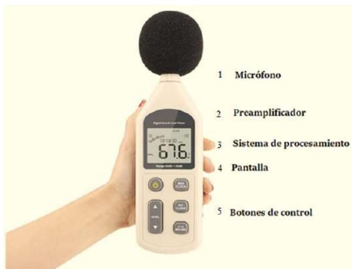
Figura 2.4. Partes del sonómetro
