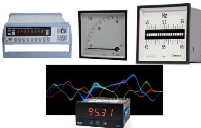
Figura 2.44. Tipos de frecuencímetros.
