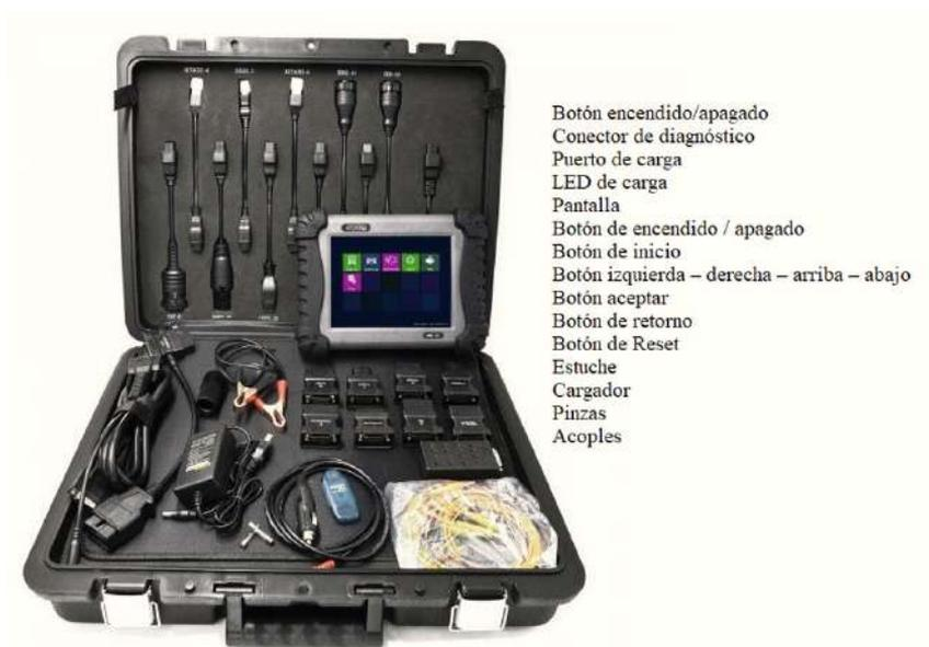
Figura 2.90. Partes del escáner.
