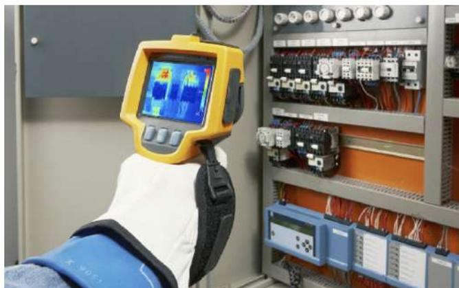
Figura 2.86. Aplicación de la cámara termográfica
