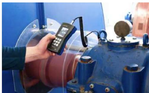
Figura 2.26. Aplicación del acelerómetro en la industria
