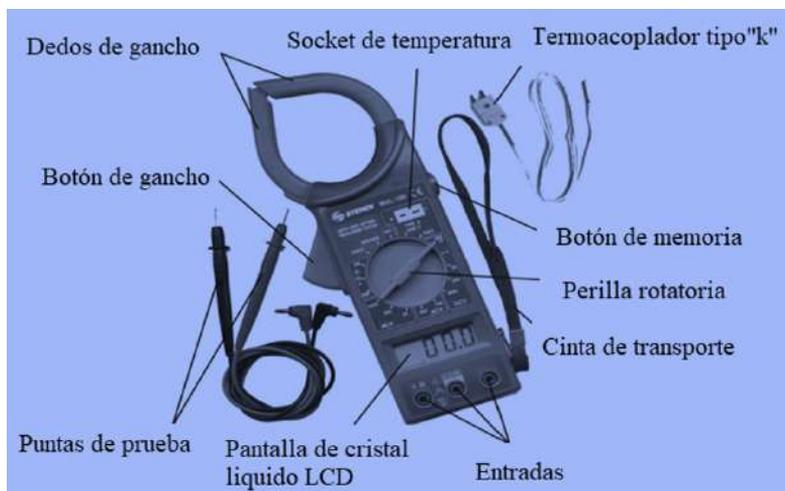
Figura 2.73. Partes del multímetro digital
