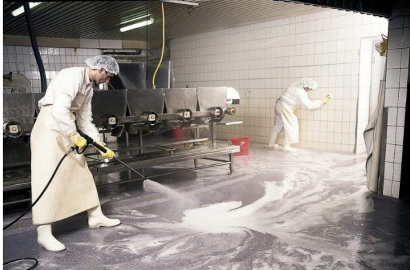
Imagen 3.61 Proceso de limpieza y desinfección para diluir las poblaciones microbianas.
