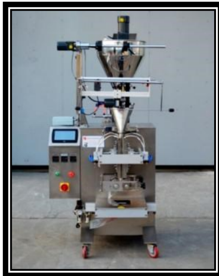
Imagen 3.86 Máquina envasadora de yogurt automática. Fuente: catálogo de lempaque, 2022
