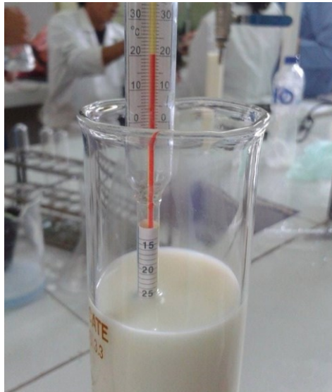
Imagen 3.58 Técnica de la probeta para la densidad de la leche.
