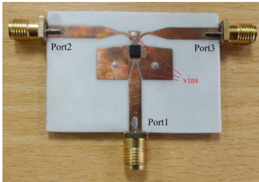
Fig.11. Implementación de Balun MMIC MTX2-143+ para trabajar de 5.5 a 13.5 GHz. a) Vista frontal b) Vista posterior.
