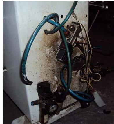
Figura N° 1. Situación inicial del sistema neumático
