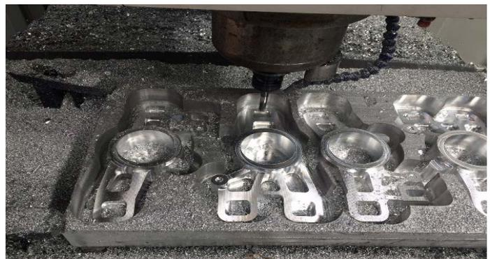
Figura 11. Parte del proceso de mecanizado
