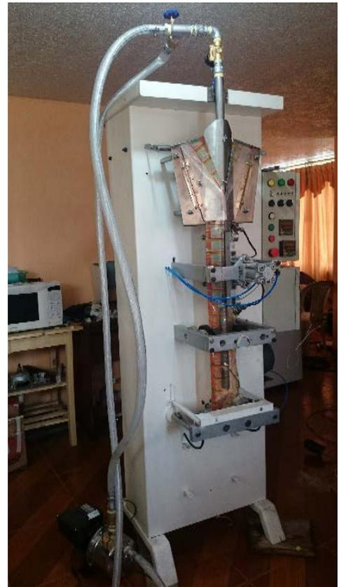
Figura N° 7 Envasadora lineal repotenciada y automatizada
