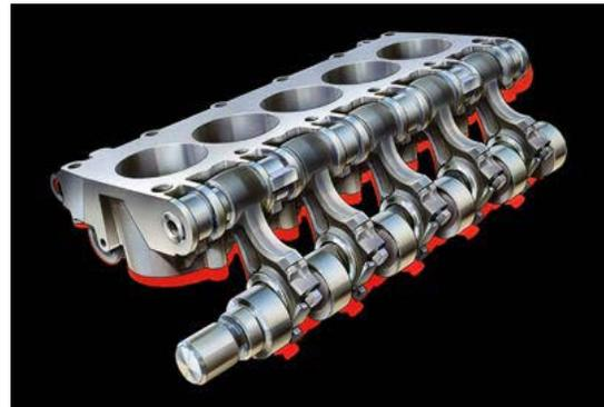
Figura 8. Mecanismo de Variación de la Relación de Compresión
