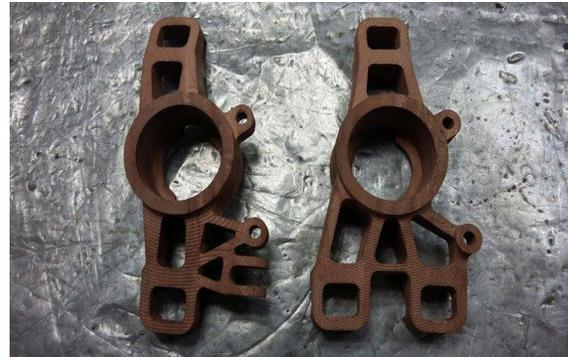
Figura 9. Prototipo en madera (original a color)
