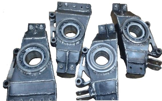
Figura 1. Manguetas originales del monoplace F-SAE
