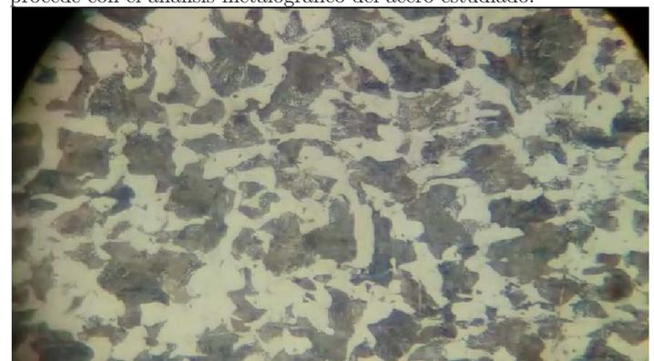
Figura 8 Microestructura del acero ensayado, atacado con Nital al 2%. Ampliación 500 X Fuente: AUTORES
