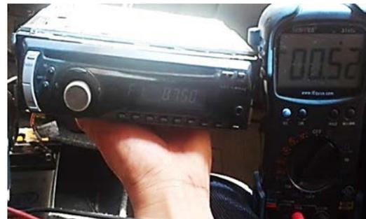
Fig. 9 Prueba de alimentación en el equipo de audio convencional
