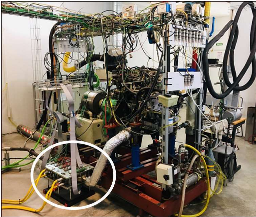
Figura 3. Vista lateral-frontend del banco de ensayos. En óvalo blanco aparece destacado el generador termoelectrico montado en el conducto de escape.
