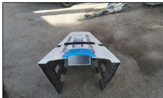
Figura 10. Visera de la pantalla TFT fabricada con fibra de vidrio
