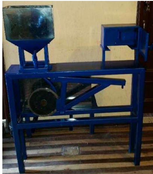
Figura 7. Equipo construido según norma ASTM G-65
