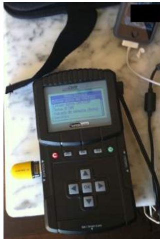
Fig. 2.19. Extracción lógica de datos de la SIM.
